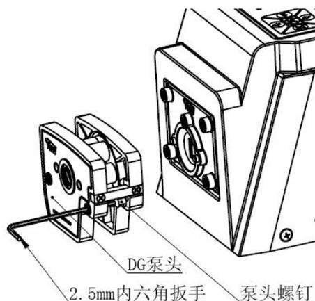
安装泵头时，请先去除卡片，将泵头主轴对准联轴套的凹槽，将泵头轴承的扁头插入联轴套的凹槽中，如果泵头轴承扁头与凹槽方向不匹配，可以转动泵头滚轮来调整。
