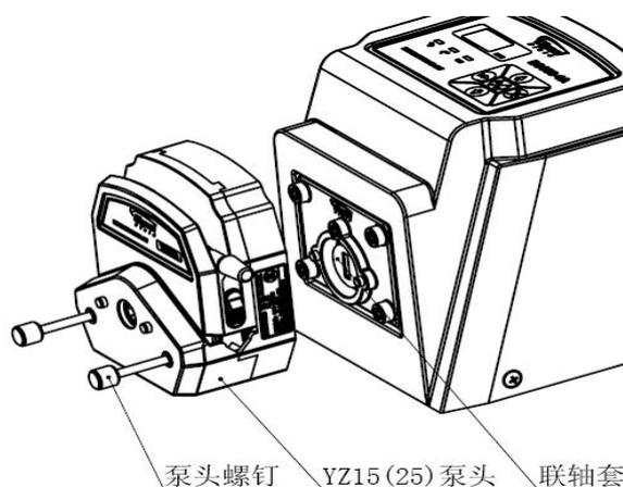
安装泵头时，请将泵头主轴对准联轴套的凹槽，将泵头轴承的扁头插入联轴套的凹槽中，如果泵头轴承扁头与凹槽方向不匹配，可以转动泵头滚轮角度来调整后再对接。
