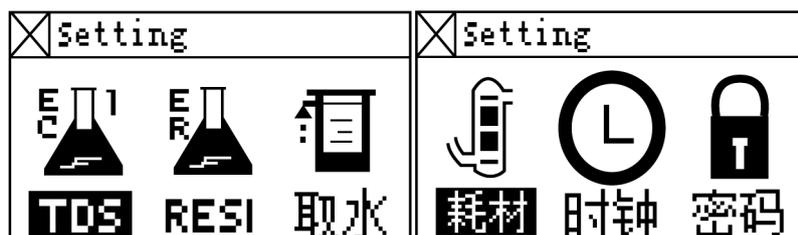
②TDS 水质超标报警设置：移动光标至 TDS 键，然后按确认键进入 TDS 水质超标报警设置界面，通过移位键以及增量键进行设置数值。
