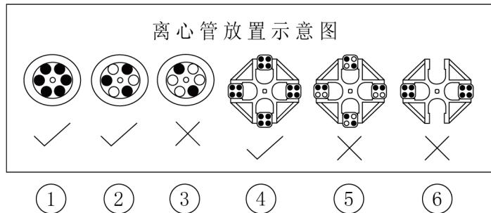
图 1 到图 3 为角转子的示意图，图 4 到图 6 为水平转子的示意图
